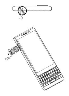
1. 同梱のピンを端末側面の小さな穴に差し込みます
